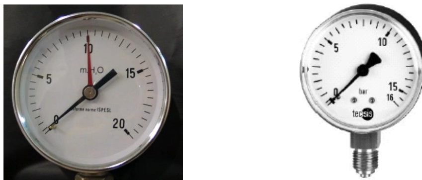
Figura 31. Esempi di manometri metallici con diverse scale di graduazione.
